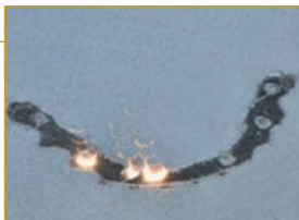
图1: 选择性激光熔化工艺 (左图) 与 Ti6Al4V 牙科植入上部结构 SLM 生产 (右图) 示意图
