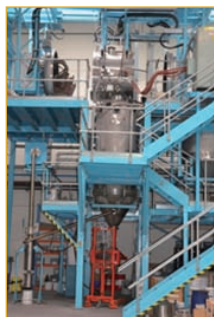
我司西班牙工厂的 真空感应熔炼气雾化装置
