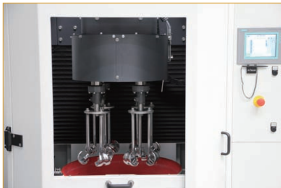
图4：4 个工件轴拖拽式光饰机，型号 R..SF，带操作触屏
