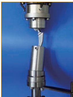
图1 一个髋关节柄的疲劳试验
