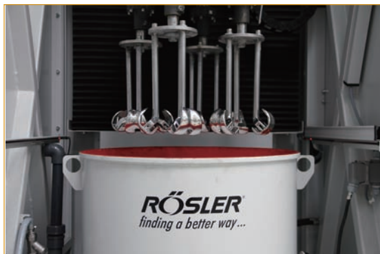
图 6：装夹一批膝关节植入物的拖拽式光饰机
