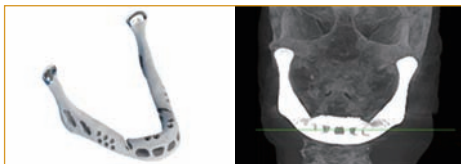
图2：采用SLM生产的定制下颌植入物（材料：Ti6Al4V ELI）
