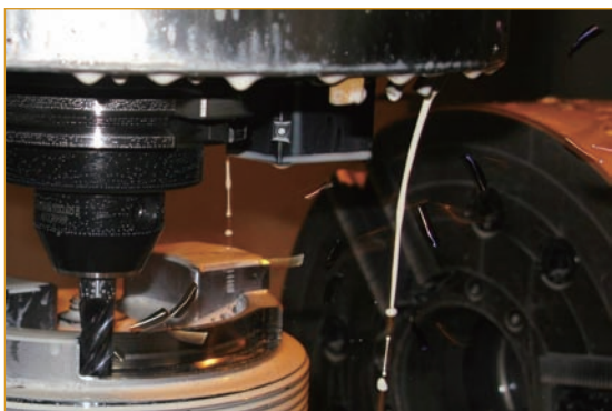
图4：钛合金用不等导程UVX铣刀加工
